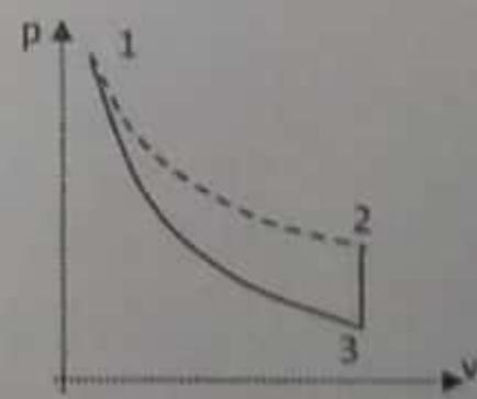
**Problema 4 (Física IIA y 82.02):** Se considera un mol de un gas ideal diatómico. El proceso 1-2 es una isoterma irreversible; 1-3 es una adiabática reversible; 2-3 es una isocora reversible. Se utiliza el ciclo para una máquina térmica. (Datos : p<sub>1</sub>= 200 kPa; T<sub>1</sub>= 500 K; p<sub>3</sub>= 50 kPa)
